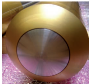
Testa del pistone rivestita con carburo di Tungsteno un acciaio low alloy.
